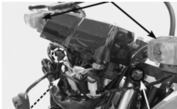
CONECTORES TAMPA DA COLUNA DE DIREÇÃO
