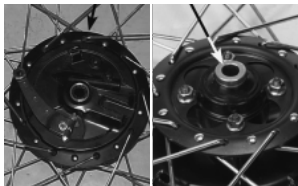
EXTREMIDADE DO CABO DO FREIO ESPELHO DE FREIO
