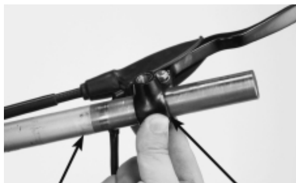
GUIDÃO SUPORTE DA ALAVANCA DO FREIO PARAFUSOS DOS SUPORTES DO GUIDÃO
