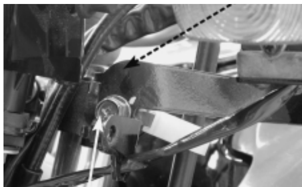
PARAFUSO DE FIXAÇÃO DA MESA SUPERIOR
