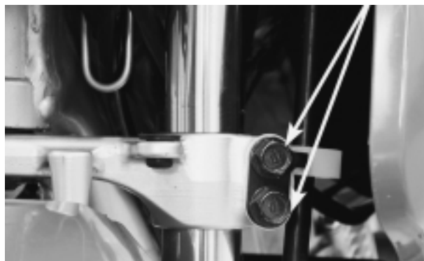
PARAFUSOS DE FIXAÇÃO DA MESA INFERIOR
