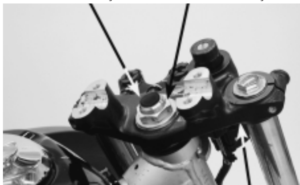
MESA SUPERIOR PORCA DE AJUSTE DA COLUNA DE DIREÇÃO
