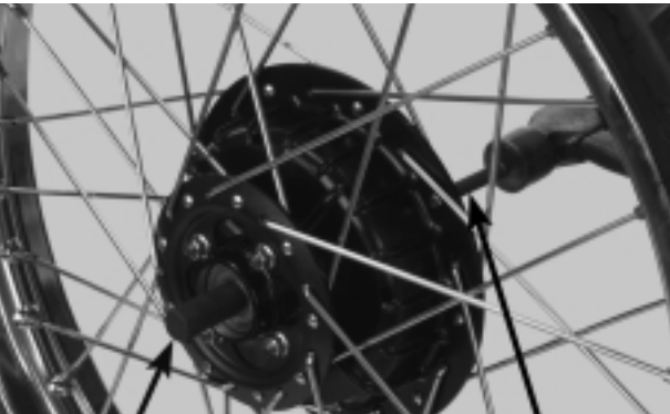
CABEÇOTE DO EXTRATOR EIXO DO EXTRATOR
