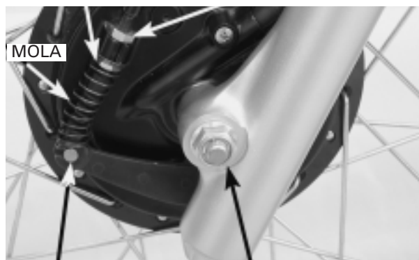
EXTREMIDADE DO CABO DO FREIO ESPELHO DE FREIO
